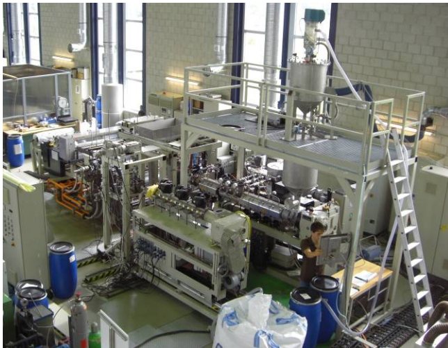
Extrusionsanlage im Technikum des IKV (Bild IKV)
