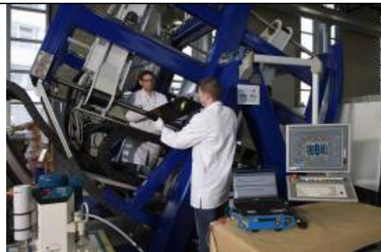
Spaltimpregnieranlage im IKV-Technikum für FVK (Foto: IKV/Winandy)
