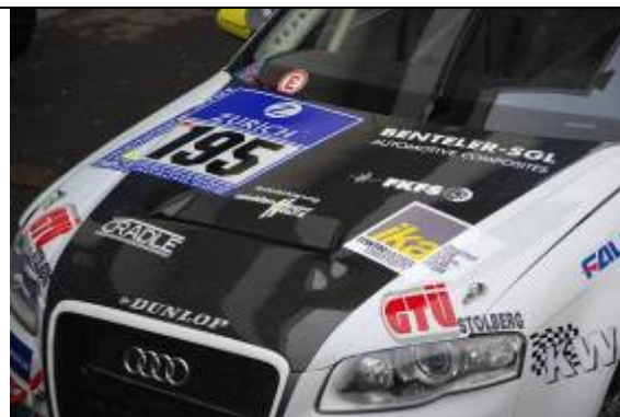
Motorhaube des Rennwagens in CFK-Integralbauweise, eine gemeinsame Entwicklung von ika und IKV (Bild: ika/IKV)
