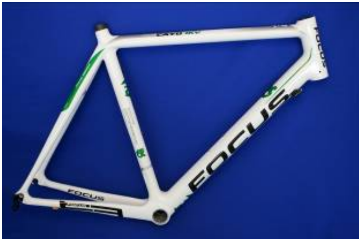
Neu entwickelter Rennrad-Rahmen aus CFK mit hoher Steifigkeit und geringem Gewicht (Bild:IKV)
