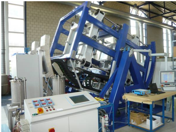
Spaltimpregnieranlage im FVK-Technikum des IKV (Bild: IKV)
