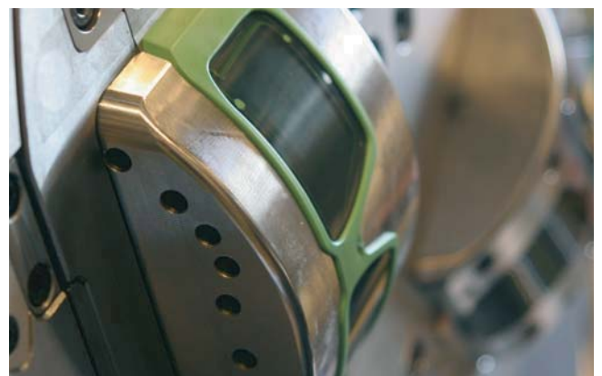
Blick auf Sportbrille im Drei-Stationen-Werkzeug (Bild: IKV)
