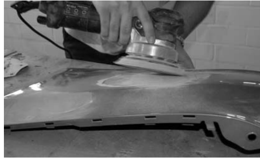
Bild 5.8: Reparatur eines Kunststoffstoßfängers
