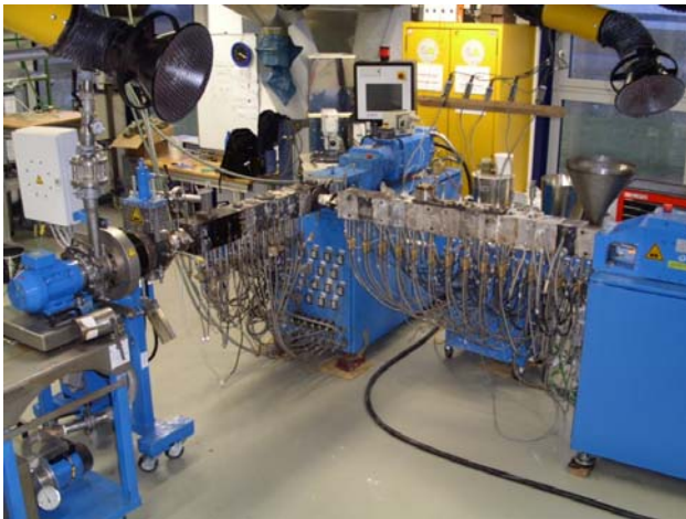
Bild: Doppelschneckenextruderkaskade mit Unterwassergranulierung
