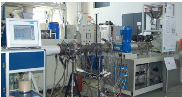
Schaumextrusionsanlage mit dem OptiFoam™-System im Technikum des IKV
