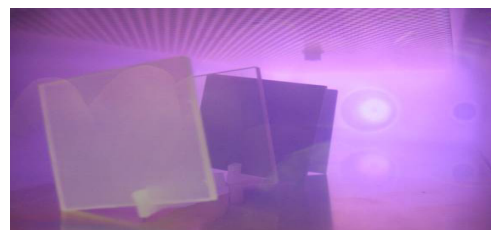
Sauerstoffplasma zur Oberflächenaktivierung
