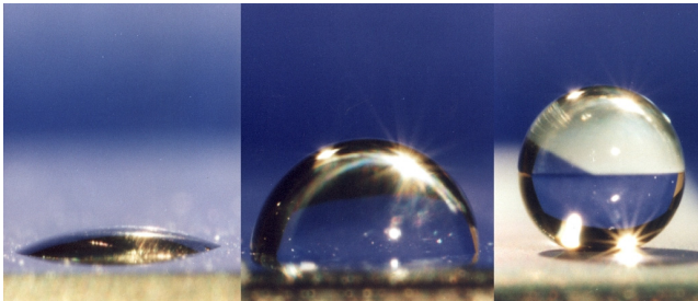
Plasmagestützte Modifikation der Benetzungseigenschaften
