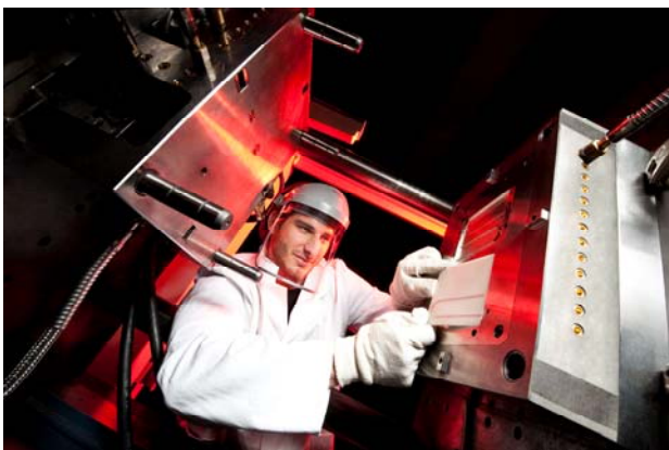
Bild: Thermoplast und Metall werden in einem Werkzeug urgeformt (Hybrides Mehrkomponenten Spritzgießen)
