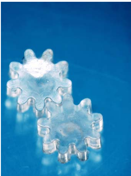
Mittels Ultraschallplastifizierung und Direktioninjektion hergestellte Mikrozahlräder
