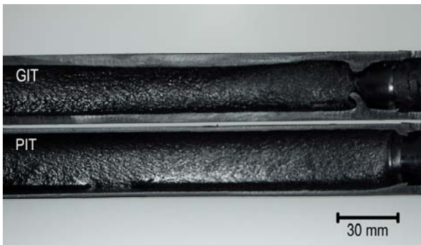
Bild: Exemplarischer Vergleich der Hohlraumbildung zwischen GIT und PIT
