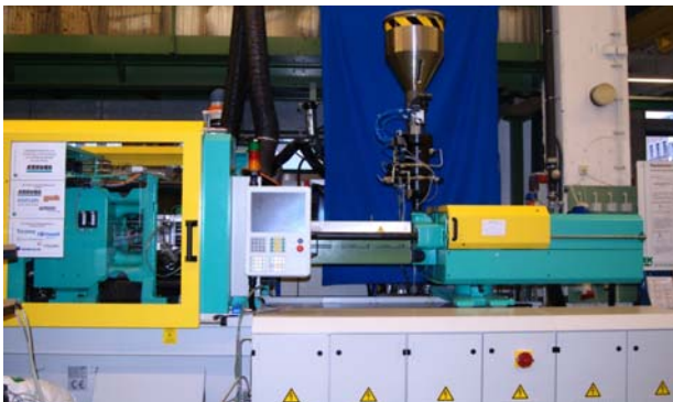
Mit dem am IKV entwickelten ProFoam-Verfahren ausgestattete Spritzgießmaschine
