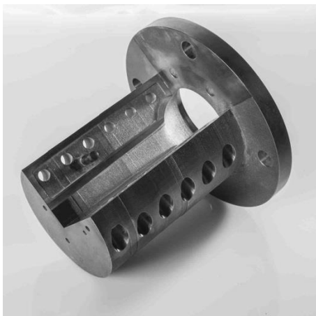
Additiv gefertigtes Demonstratorwerkzeug (Foto: IKV/Fröls)
