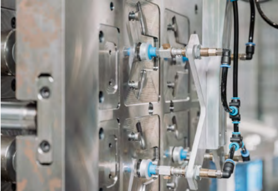
Automatischer, kombinierter Tiefzieh-/Hinterspritzprozess von mikroformschlüssig gefügten hybriden Bördelkappen. / Automatic, combined deep drawing/back injection process of microform-fitted hybrid crimp caps
