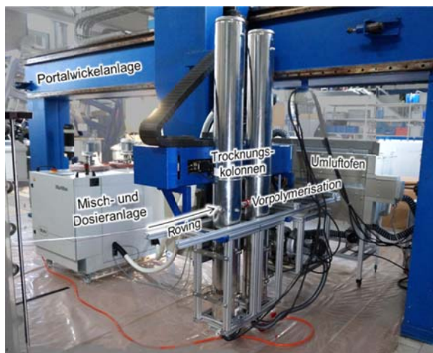
Am IKV entwickelte Anlagentechnik zur Verarbeitung von in-situ polymerisierenden Thermoplasten (Foto: IKV)
