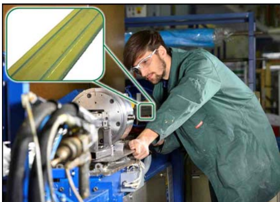
Inbetriebnahme der neuen Werkzeugtechnik mit Detailaufnahme des pultrudierten Profils (Foto: Fröls/IKV)
