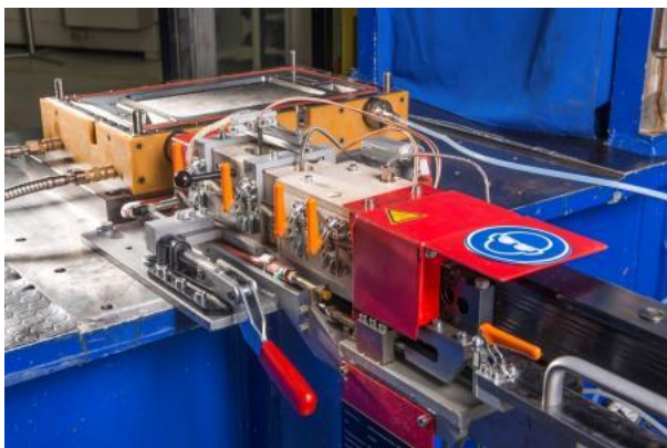
Neuartige Injektionseinheit zur automatisierten und qualitätsgesicherten RTM-Fertigung (Foto: IKV/Fröls)
