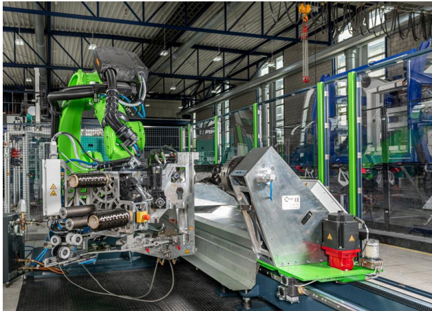
Gesamtansicht der neuen, roboterbasierten Wickelanlage im FVK-Technikum des IKV
