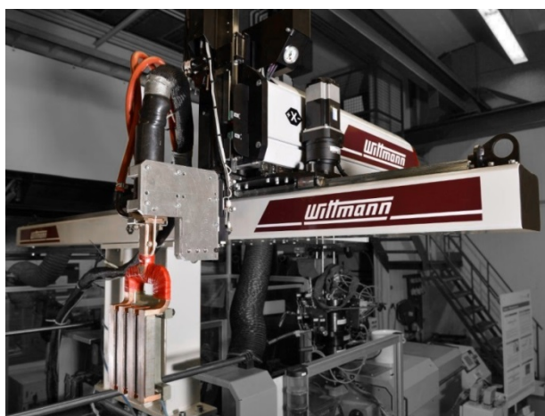
Neuer Roboter der Wittmann Robot Systeme GmbH mit Induktor zur variothermen Temperierung (Foto: Fröls/IKV)
