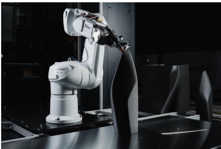
Robotergeführte, großvolumige Additive Fertigung am IKV (Bild: IKV/Fröls)
