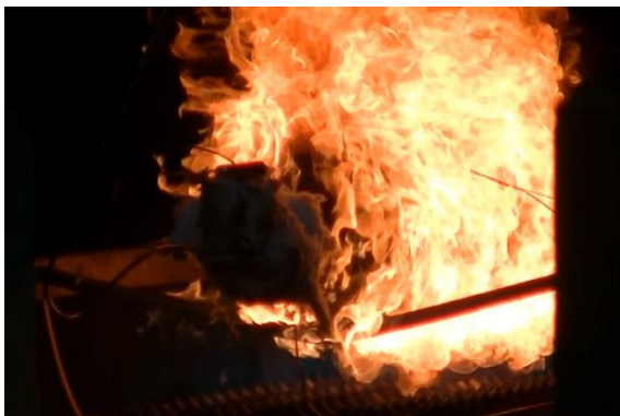
Versagen im Brandversuch eines Typ-IV Wasserstoffdrucktanks | Bild: TesTneT Engineering GmbH
