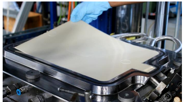
Trennmittelfreie Herstellung von PUR-Bauteilen mit optimierten Oberflächenstrukturen | Foto: IKV
