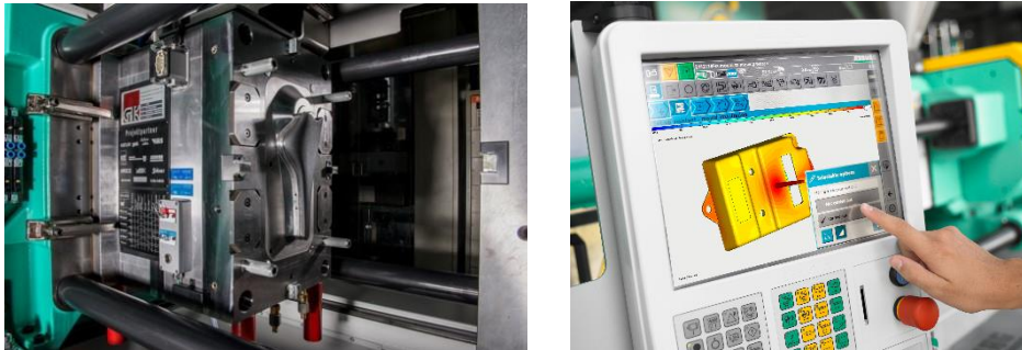
Das Zusammenspiel aller Fertigungskomponenten vom Werkzeug (links) bis hin zum Formteil und der Steuerung (rechts) ist verantwortlich für die Bauteilqualität [IKV, Arburg]
